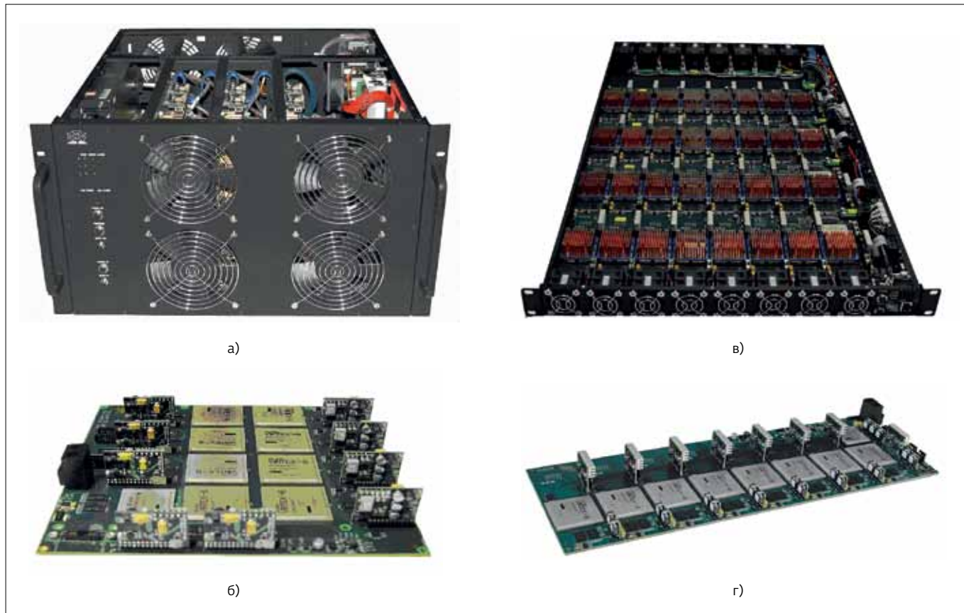
Рис.6. Вычислительный модуль "Саиф" (а), его плата (б), модуль "Ригель" (в) и его плата (г)
