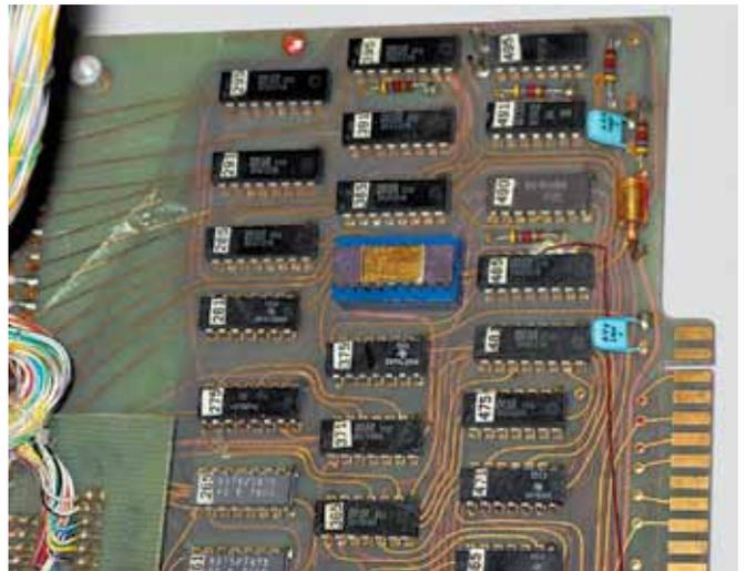
**Рис.1.** Компьютерная плата с процессором Intel 8008 1972 года [1]
