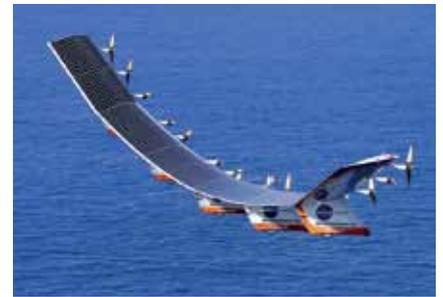
**Рис.7.** Беспилотный самолет на солнечных батареях
