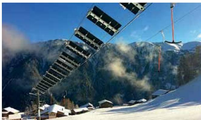
**Рис.4.** Подъемник в Тенне, работающий на солнечной энергии
