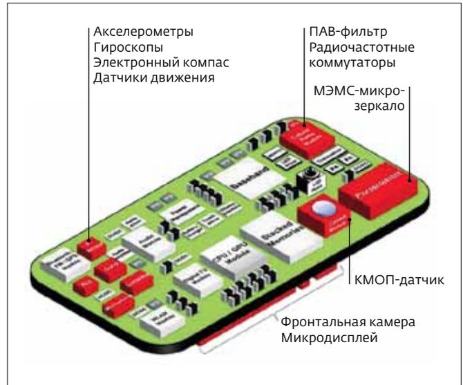
Рис.3. МЭМС компоненты (выделены красным) типового смартфона (данные компании Yole Developpment)
