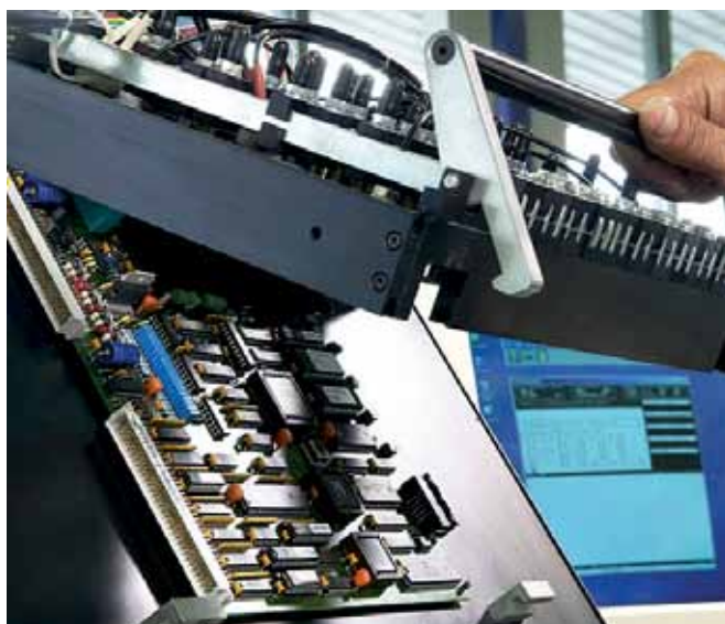
Рис.1. Автомат электрического тестирования с адаптером "ложе гвоздей"
