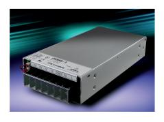
основанием 105×218 мм (4,1×8,6 дюйма) и высотой 41 мм (1,6 дюйма). Номинальная мощность — до 500 Вт, удельная мощность — 8,7 Вт/дюйм<sup>3</sup>. Выходное напряжение может регулироваться потенциометром или внешним источником напряжения.
