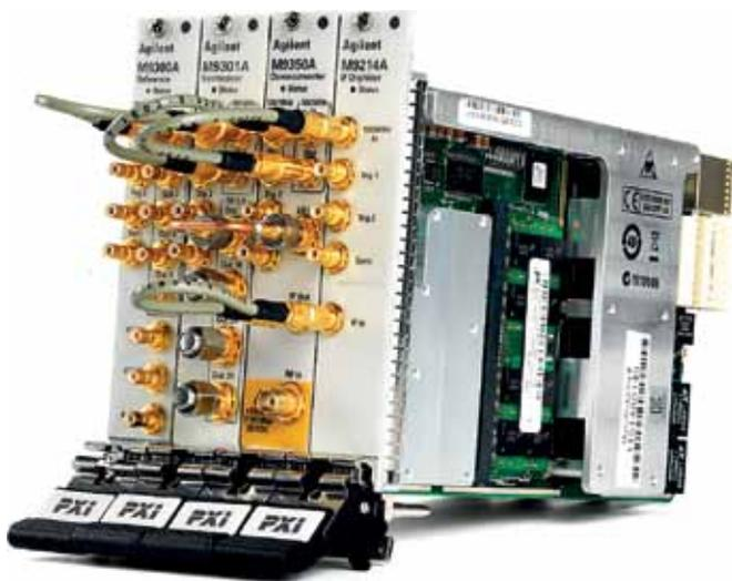
Рис.2. Векторный анализатор сигналов M9391A
