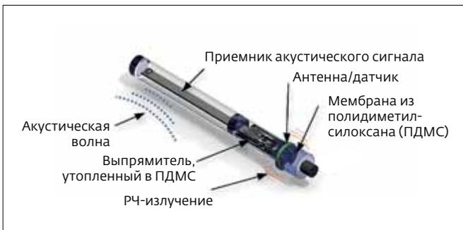
**Рис. 4.** Имплантируемый датчик, который питается энергией, генерируемой пьезоэлектрическим МЭМС под воздействием музыки (рэпа, блюза, джаза, рока)
