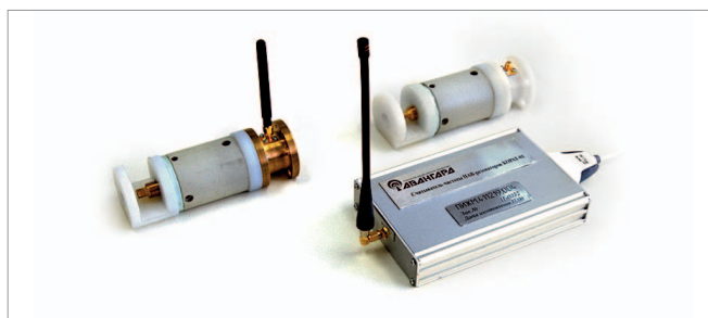
Рис.9. Пассивные акустоэлектронные датчики напряженно-деформированного состояния и считыватель показаний
