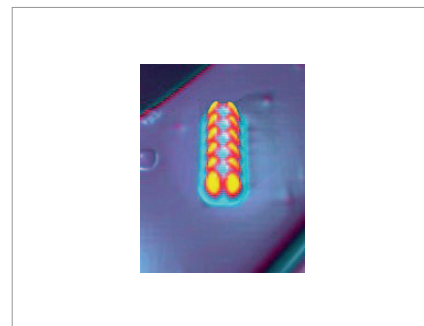
Рис.3. СТМ-изображение 12 атомов железа, собранных на атомном уровне в антиферромагнетик
