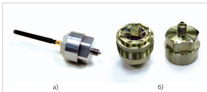
Рис.8. Акустоэлектронные датчики давления: пассивный (а), активный (б)
