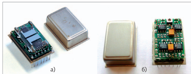
Рис.6. Акустоэлектронный (а) и пьезокерамический (б) гироскопы
