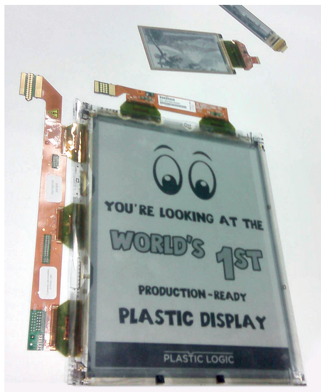
Рис.16. Первый в мире пластиковый дисплей, готовый к производству, компании Plasticlogic
