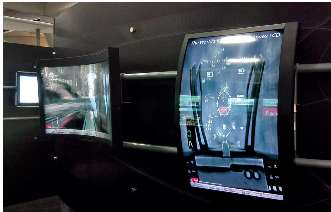
Рис.6. Вогнутые и выпуклые дисплеи для автомобилей компании BSI
