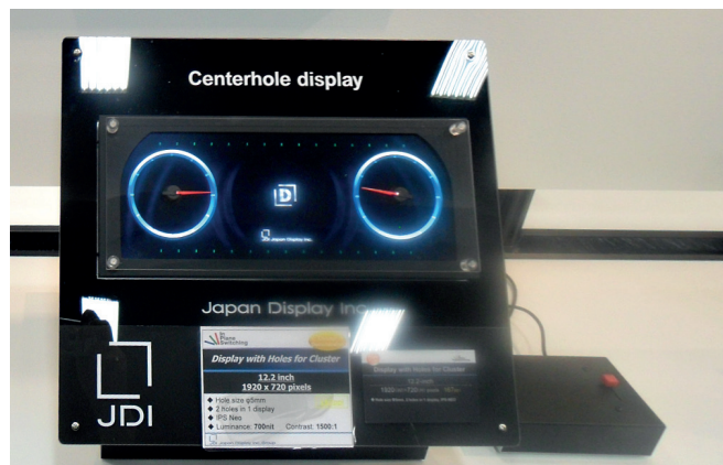
Рис.7. ЖК-панель компании Japan Display Inc. с двумя 5-мм дырками для стрелок индикаторов скорости и уровня топлива
