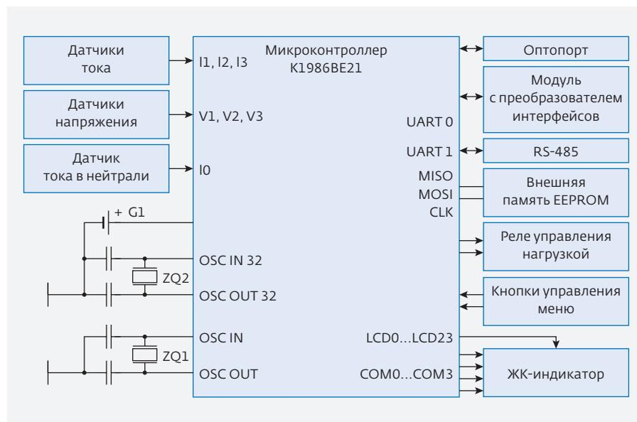
Структурная схема счетчика "Милур 306" на базе микроконтроллера K1986BE21У
