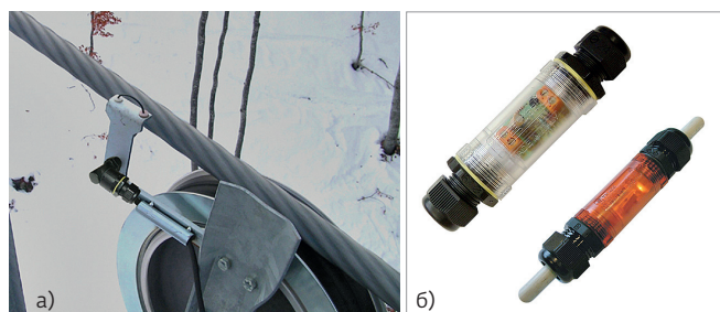
Рис.2. Примеры применения соединителя TEETUBE: электрооборудование лыжного подъемника (а); корпуса электронных узлов (б)
