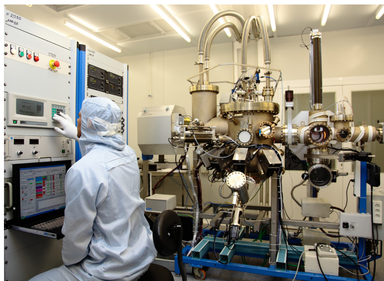
Установка молекулярно-лучевой эпитаксии Riber Compact 21T
