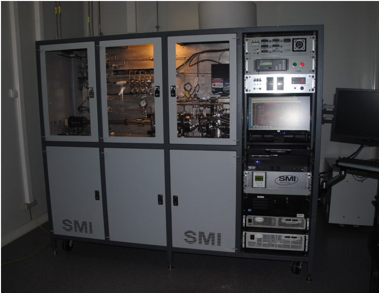
Установка эпитаксии из газовой фазы EPIC CVD компании SMI
