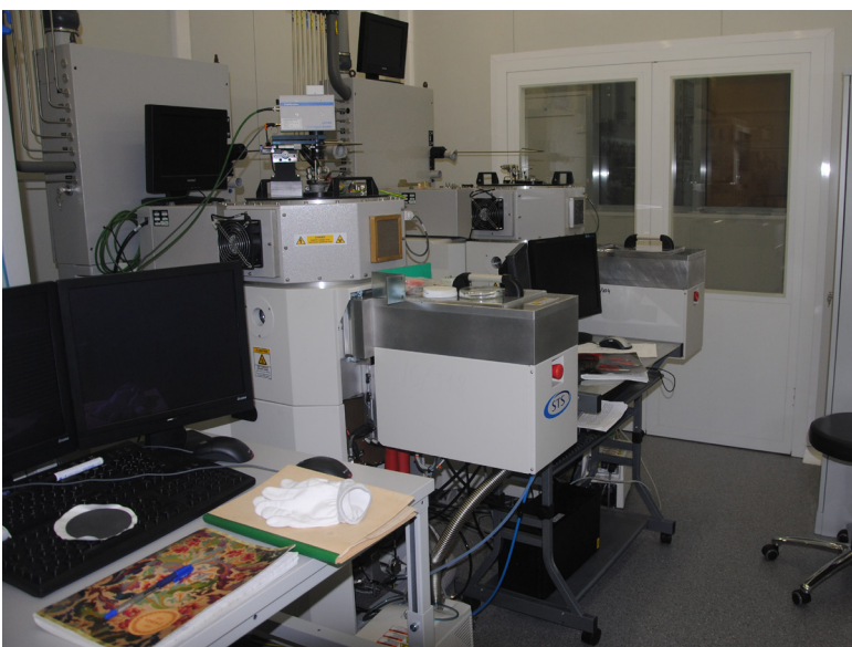
Системы ионно-реактивного плазмохимического травления SPTS LPX ICP компании SPP Process Technology Systems (Orbotech)
