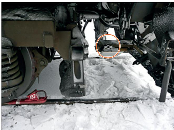
**Рис.2.** Считывающее устройство, установленное на поезде
