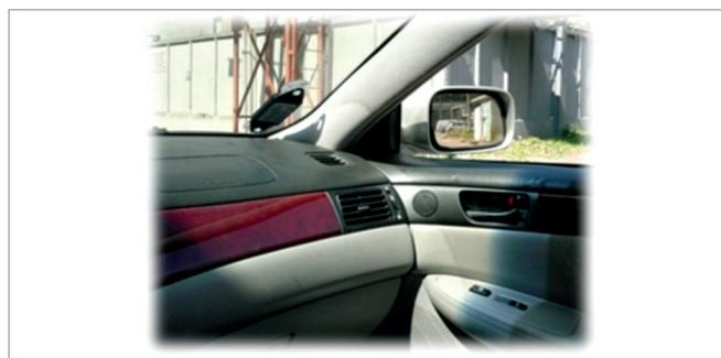
**Рис.8.** ПАВ-метка, закрепленная на лобовом стекле автомобиля
