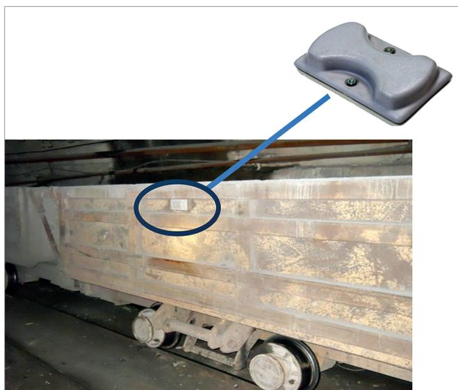
**Рис.6.** Размещение ПАВ-метки на вагонетке
