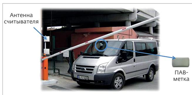
Рис.9. Система РЧИД ПАВ при въезде автотранспорта на подконтрольную территорию
