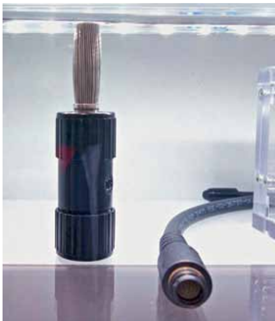
Первый коннектор Отто Дункеля – подпружинен- ный контакт Single contact
