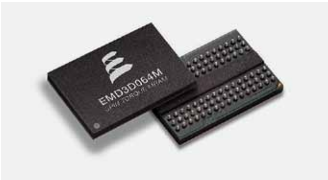
Рис.4. STT MRAM емкостью 64 Мбит компании Everspin
