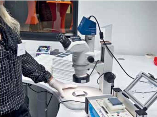
Участок оптической инспекции и электрического тестирования
