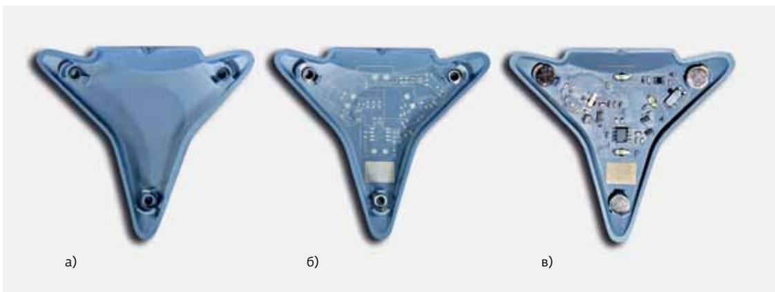
Деталь после отливки (а), прямого лазерного структурирования (б) и монтажа компонентов (в)
