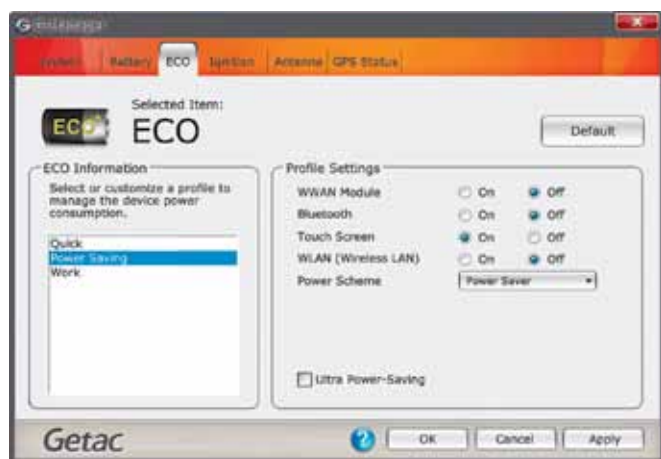
Рис.5. Утилита G-Manager для настройки схемы управления питанием
