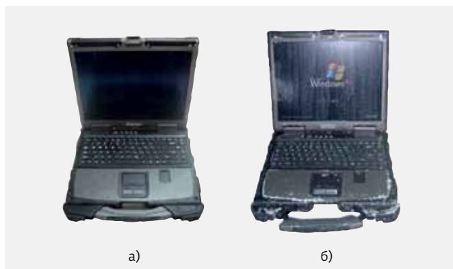
Рис.7. Наглядная иллюстрация работы технологии антикоррозийной защиты: изделие с покрытием (а) и без него (б) после обработки солью
