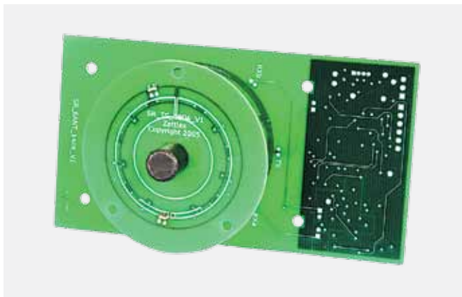
Рис.8. Датчик вращения с разрешением 16384 отсчета на оборот
