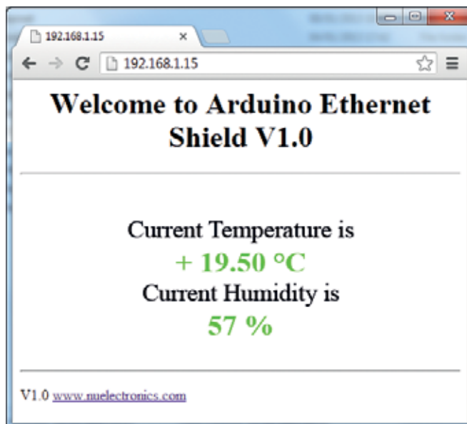
Рис.5. Файл Ethernet экрана системы Arduino с показаниями температуры и влажности датчика DHT11
