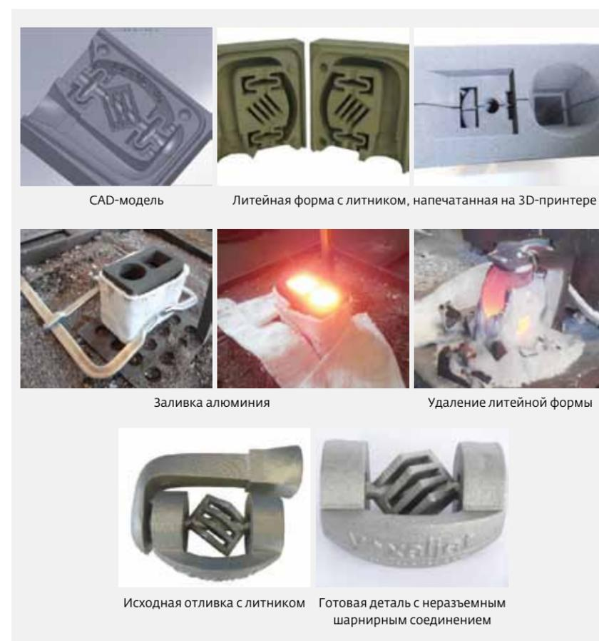
**Рис.12.** Отливка на основе песчаных литейных форм, напечатанных на 3D-принтере voxeljet
