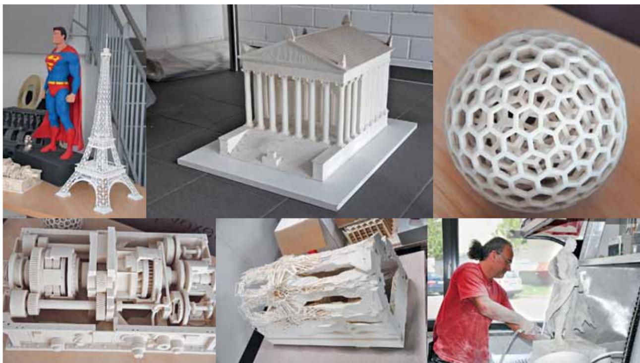
**Рис.10.** Все это напечатано на принтерах voxeljet
