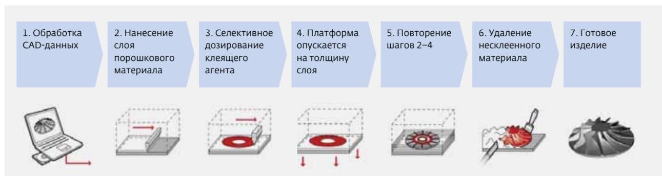
Рис.1. Принцип 3D-печати по технологии voxeljet
