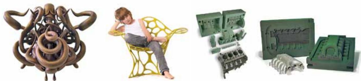
Рис.13. Образцы изделий, литейные формы для которых напечатаны на 3D-принтере voxeljet – от сложной дизайнерской конструкции и дизайнерского алюминиевого кресла до узлов двигателей
