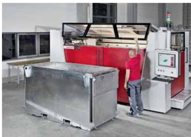
Рис.4. Принтер VX2000. На переднем плане – сменный рабочий короб
