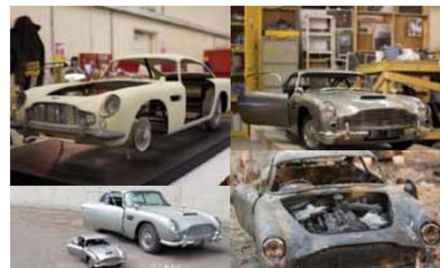
**Рис.11.** Пластиковая модель 1:3 легендарного автомобиля Джеймса Бонда Aston Martin DB5 для фильма "007. Координаты: "Скайфолл", напечатанная на VX1000
