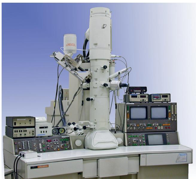
Рис.8. Просвечивающий электронный микроскоп
