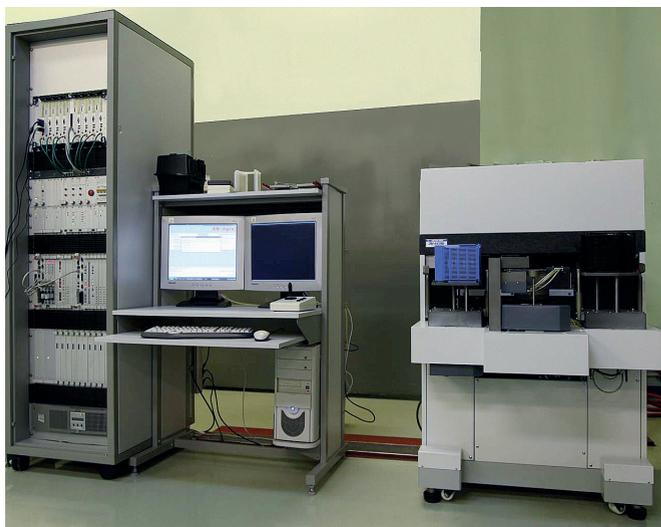
**Рис.10.** Установка контроля микродефектности ЭМ-6429
