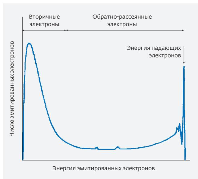
**Рис.13.** Распределение энергии электронов, эмитированных из образца
