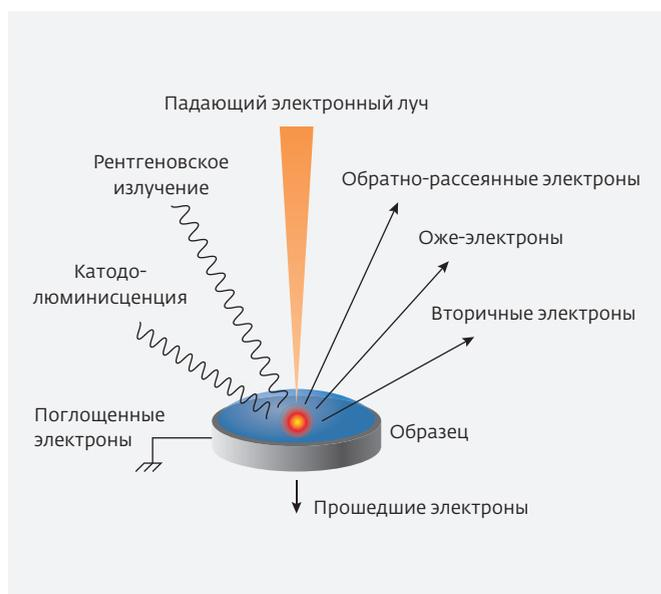
**Рис.12.** Эмиссия электронов и электромагнитных волн из образца
