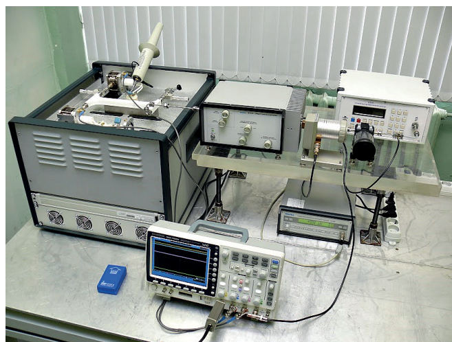
Рис.2. Модулятор с магнетронами, элементы волноводного тракта и измерительная аппаратура
