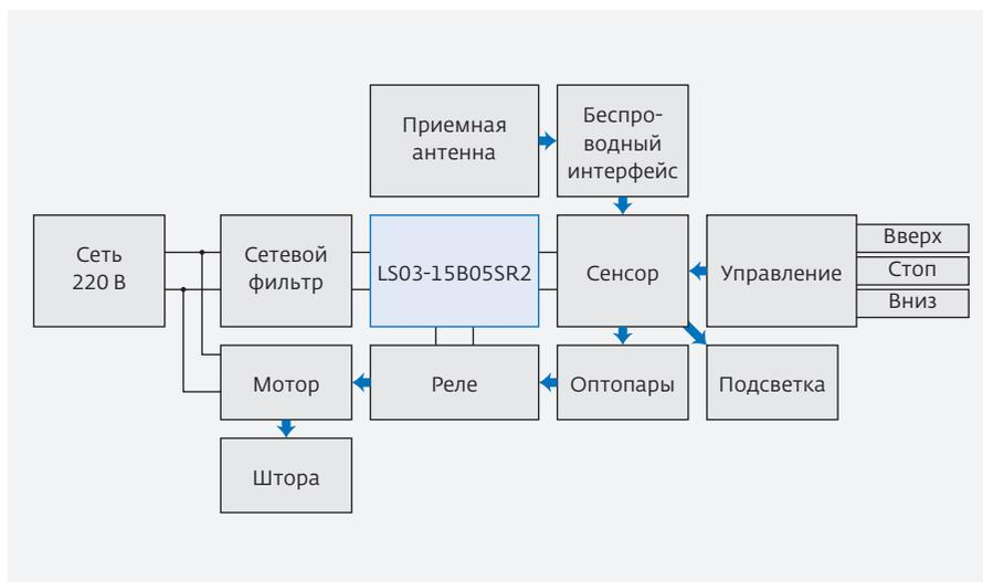
Рис.6. Схема контроллера привода штор "умного дома"
