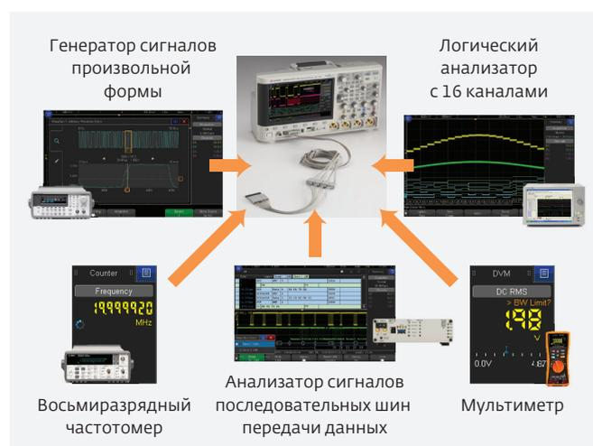
Рис.5. Различные приборы в составе осциллографа InfiniiVision 3000T
