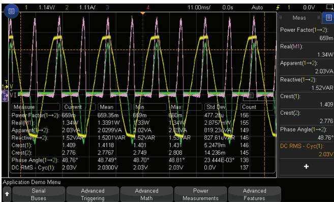
Рис.11. Интерфейс осциллографа в режиме анализа источников питания
