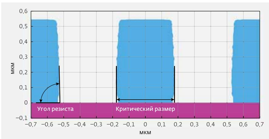
Рис.10. Критерии определения "окна процесса"
