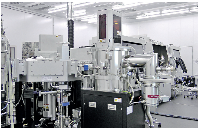
Рис.4. Технологический кластер ионно-плазменной очистки и напыления структур многономенклатурного мелкосерийного производства в Южной Корее
