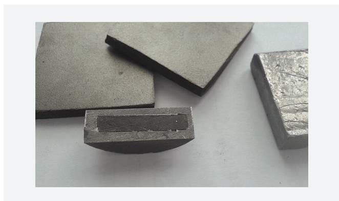
Рис.7. Экспериментальные образцы композитных пластин со вставками из пирографита
