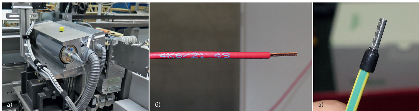
Обработка концов проводов: а - модуль ультразвуковой сварки; б - вывод после УЗ-сварки; в - вывод, армированный наконечником
