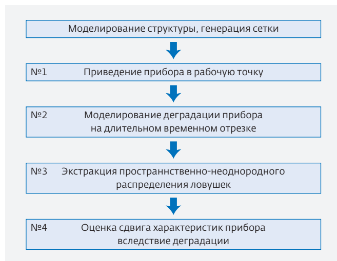
Рис.1. Схема процесса моделирования электрической деградации LDMOS-транзистора
