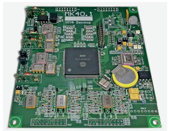
Рис.4. Контроллер МК 40.1 на базе K1921BK01T
