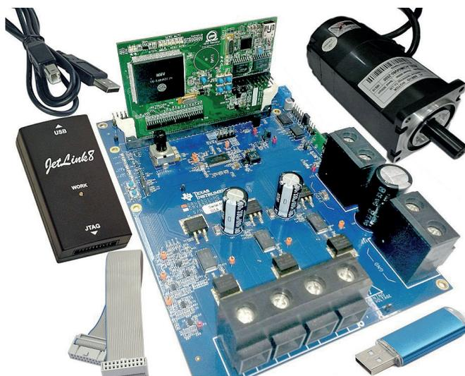
Рис.6. Отладочный комплект на K1921BK01T для управления электродвигателем
