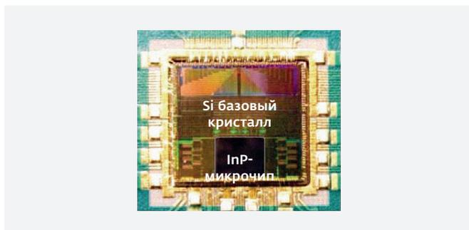
**Рис.1.** Микрофото гетероинтегральной схемы АЦП, состоящей из индийфосфидного микрочипа и кремниевго базового кристалла
