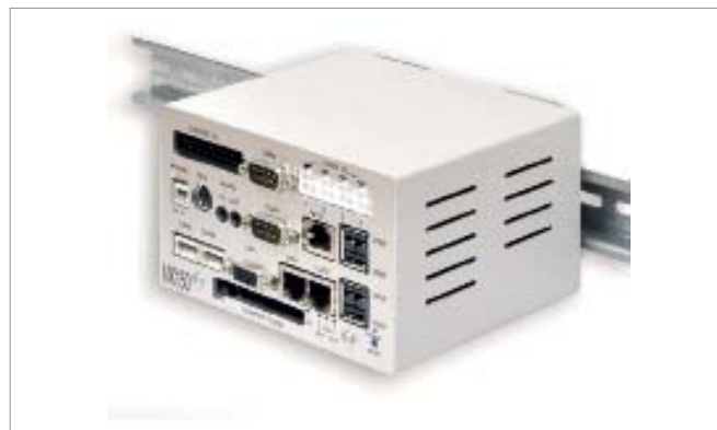
Рис.7. Модульный компьютер с поддержкой модулей Fastwel I/O
