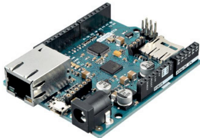
Рис.3. Модуль Arduino Leonardo ETH
