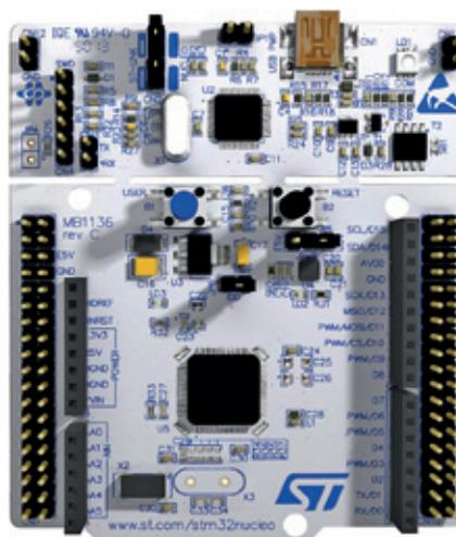
Рис.12. Плата прототипирования Nucleo-64 компании STMicroelectronics
