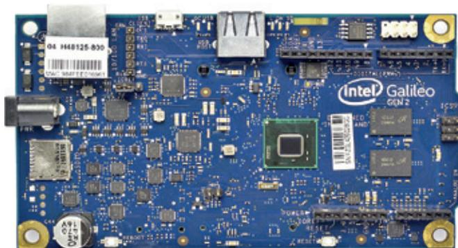
Рис.10. Плата для разработчиков Intel Galileo
