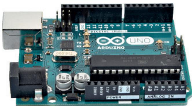
Рис.2. Модуль Arduino Uno
