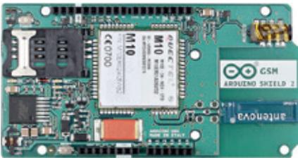
Рис.15. Плата расширения Arduino GSM Shield 2
