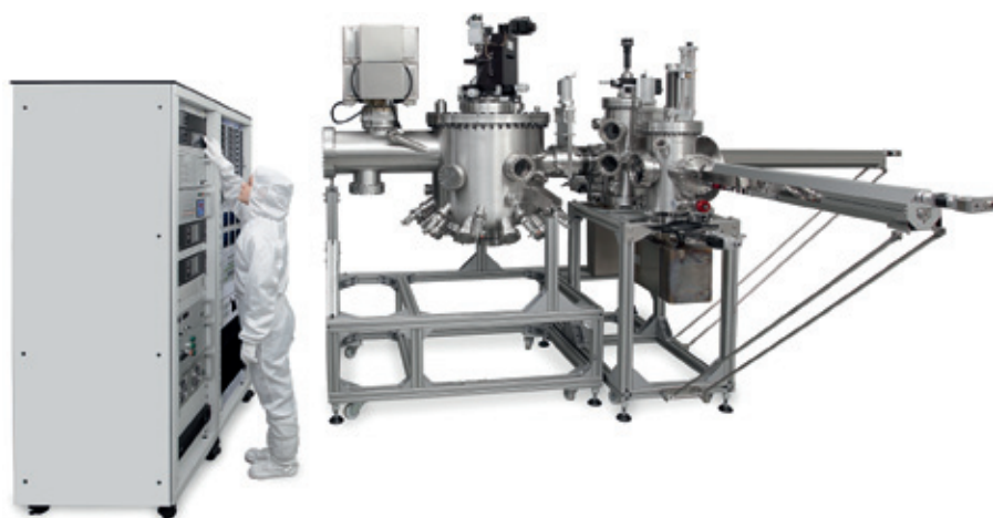
Рис.3. Обновленная система молекулярно-лучевой эпитаксии STE35
