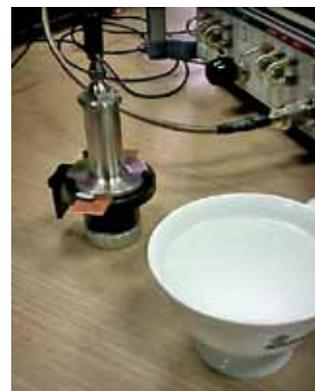
**Рис.3.** Калибровка комплекса DAK на короткое замыкание
