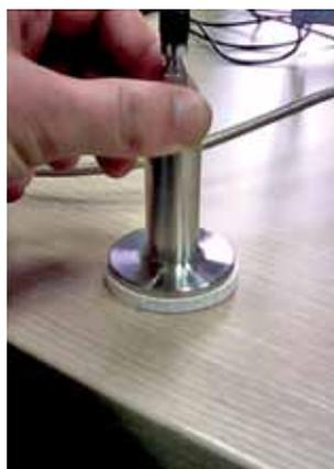
**Рис.4.** Измерение свойств композитного материала с помощью комплекса DAK
