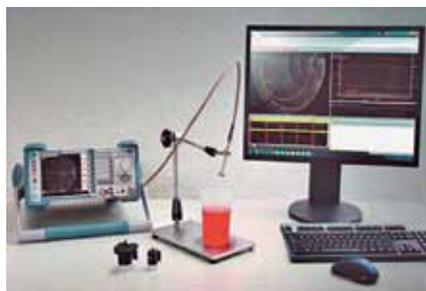
**Рис.1.** Программно-аппаратный комплекс SPEAG DAK с анализатором цепей R&S ZNB20
