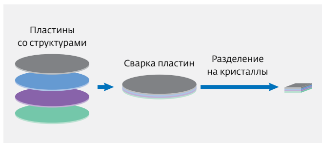
Рис.1. Иллюстрация идеи корпусирования на уровне пластины
