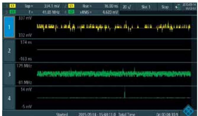
**Рис.7.** Интерфейс прибора R&S Scope Rider в режиме регистратора данных
