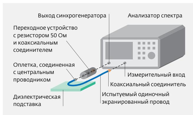
Рис.1. Схема измерения переходного поверхностного сопротивления одиночного экранированного провода
