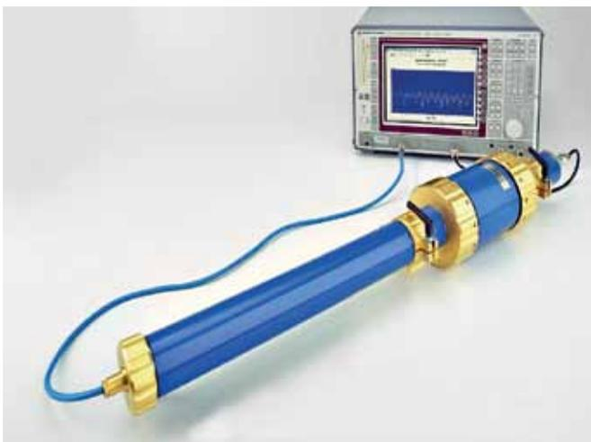
**Рис.4.** Установка для измерения эффективности экранирования с помощью триаксиальной линии с использованием оборудования компании BEDEA/Rosenberger
