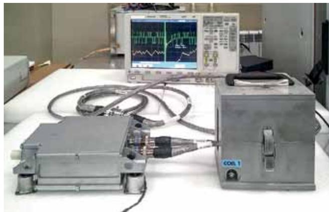
Рис.10. Испытательная установка на воздействие затухающей синусоидальной импульсной помехи
