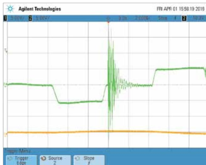
Рис.9. Осциллограмма сигнала помехи (импульсный затухающий синусоидальный сигнал) в последовательности импульсов цифрового кода
