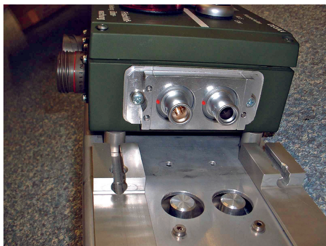
Рис.10. Разъем ODU-MAC для сопряжения радиостанции с РЛС
