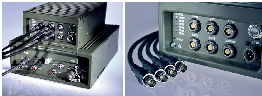
Рис.3. Защищенный мобильный маршрутизатор и компьютер Aqeri
