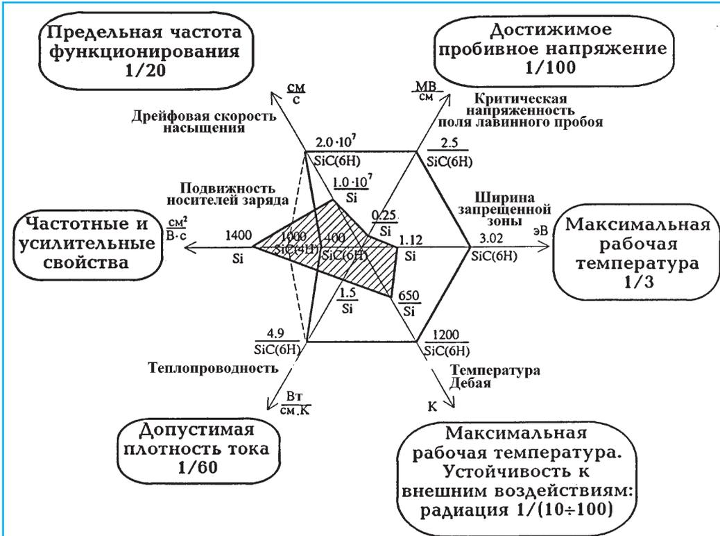
Рис. 1. Важнейшие функциональные свойства материалов кремния/карбида кремния и теоретическая оценка их влияния на экстремальные характеристики электронных приборов
