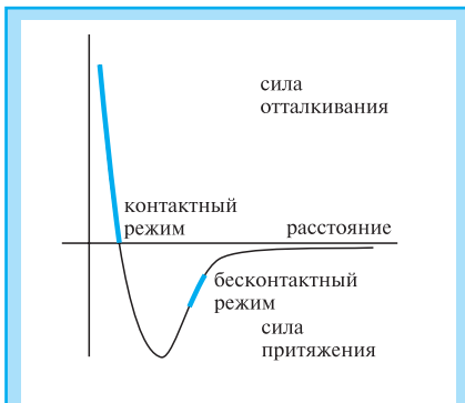
Рис.9. Зависимость сил Ван-дер-Ваальса между иглой и образцом от расстояния между ними в вакууме или газе
