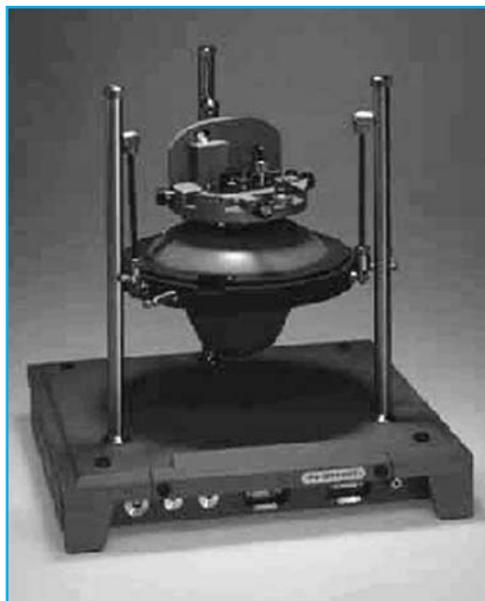
Основной блок прибора SOLVER-P4
