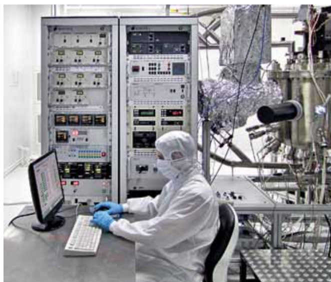
Рис.1. Модуль молекулярно-лучевой эпитаксии SemiTEq STE35 для GaAs и твердых растворов на его основе в гермозоне НОЦ "Нанотехнологии" ЮФУ
