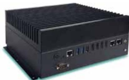
Этот компьютер – основа для создания специализированных решений. Так, для систем отображения информации предусмотрено четыре независимых видеовыхода. Надежное хранение данных на транспорте в условиях тряски обеспечивается благодаря интерфейсу m.2. Для передачи сотовых данных имеется разъем под SIM-карту. Также модуль поддерживает до восьми COM-портов.
