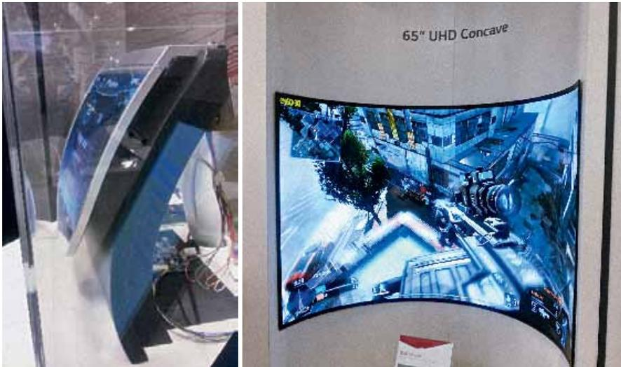
Рис.5. Выпуклые и вогнутые дисплеи (слева – дисплей компании Sharp, справа – компании LG)
