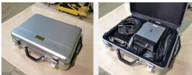
Рис.1. Спектрометр SDMF-1206PRO.DB в малогабаритном кейсе
