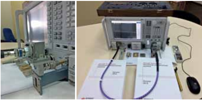
Рис.2. Измерительный стенд для калибровки и измерения параметров КВП
